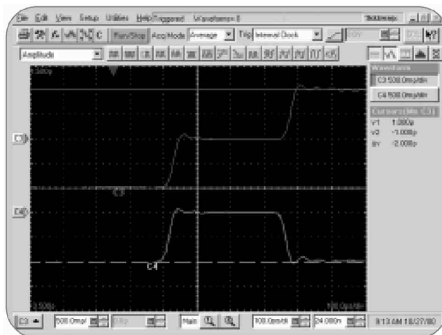
► 图21. TDS8000 数字采样示波器和 80E04 20-GHz 采样模块的时域反射仪 (TDR) 显示
