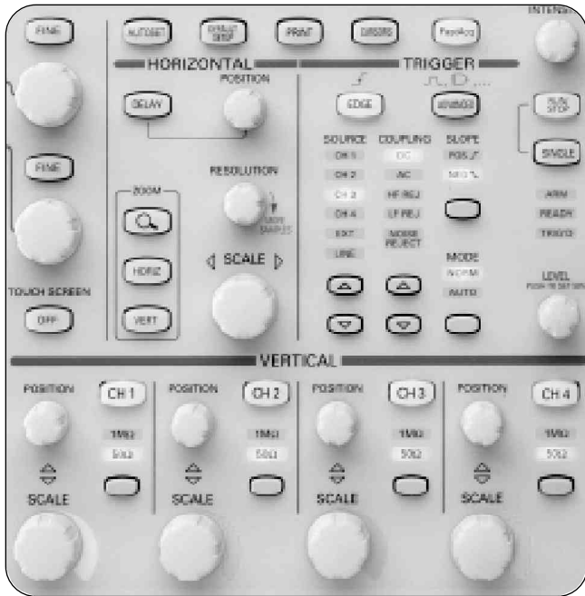
► 图22. 示波器的前面板调节控制部分
