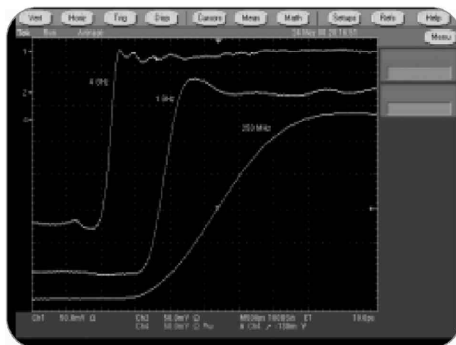
► 图47. 带宽越高, 信号的再现越准确, 图示信号的捕获速率分别是250MHZ、1GHZ 和4GHZ 带宽等级
